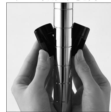
最下段の棚の取り付け位置に、テーパードスリーブの内側の凸とポストの溝が合うように、1枚ずつカチッとセットします。テーパードスリーブは裾の広がっている方を下向きにしてください。
