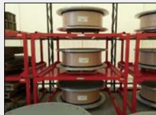
免震ゴム保管
