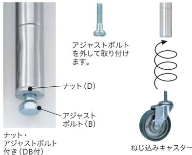
ねじ込み式キャスターには、ナット・アジャストボルト付き(DB付)のボールをご指定ください。取り付けの際は、アジャストボルトを外してキャスターをねじ込み装着します。
