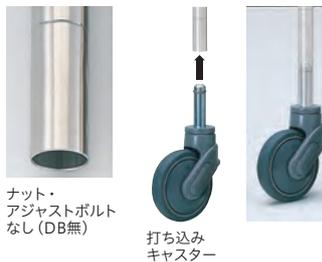
打ち込みキャスターには、ナット・アジャストボルトなし(DB無)のボールをご指定ください。ナット・アジャストボルト付きのボールに取り付ける際は、ダイカストナット・アジャストボルトを取り外して打ち込みキャスターを装着してください。
