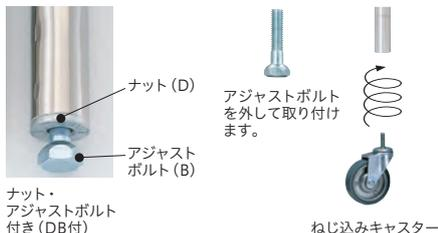
ねじ込み式キャスターには、ナット・アジャストボルト付き(DB付)のボールをご指定ください。取り付けの際は、アジャストボルトを外してキャスターをねじ込み装着します。
