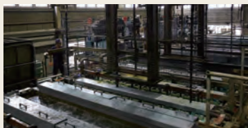
⑤-A 仕上げ「メッキ加工」 クローム色は国内有数のメッキ層で 仕上げる。錆に強く、美しい輝きを放つ。
