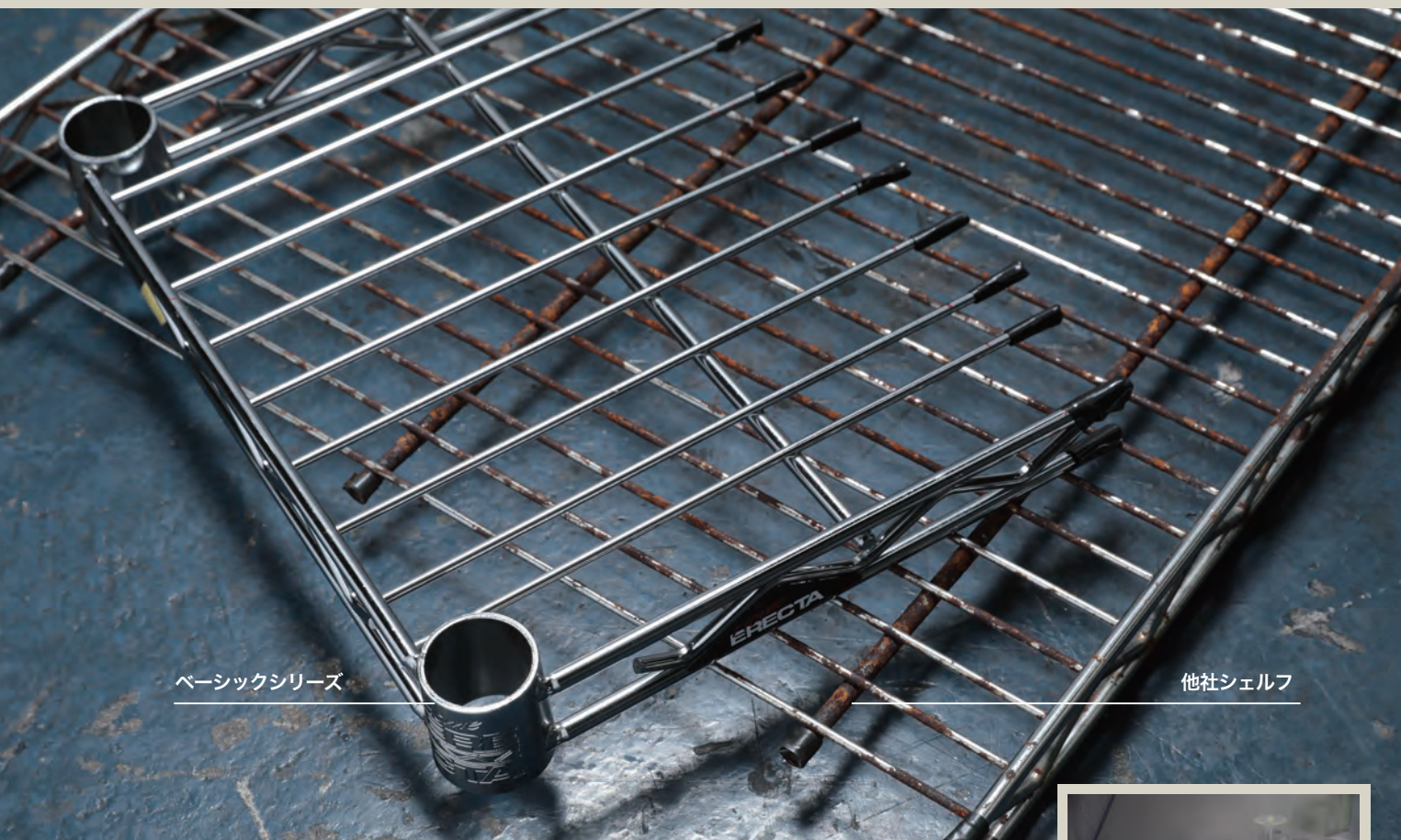
[ 72時間の塩水噴霧試験結果 ]
