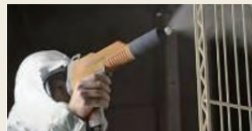
⑤-B 仕上げ「カラー粉体塗装」 塗装ブースで各色を職人が塗装します。
