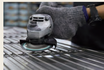
③溶接で生まれたバリを取り除きます。
