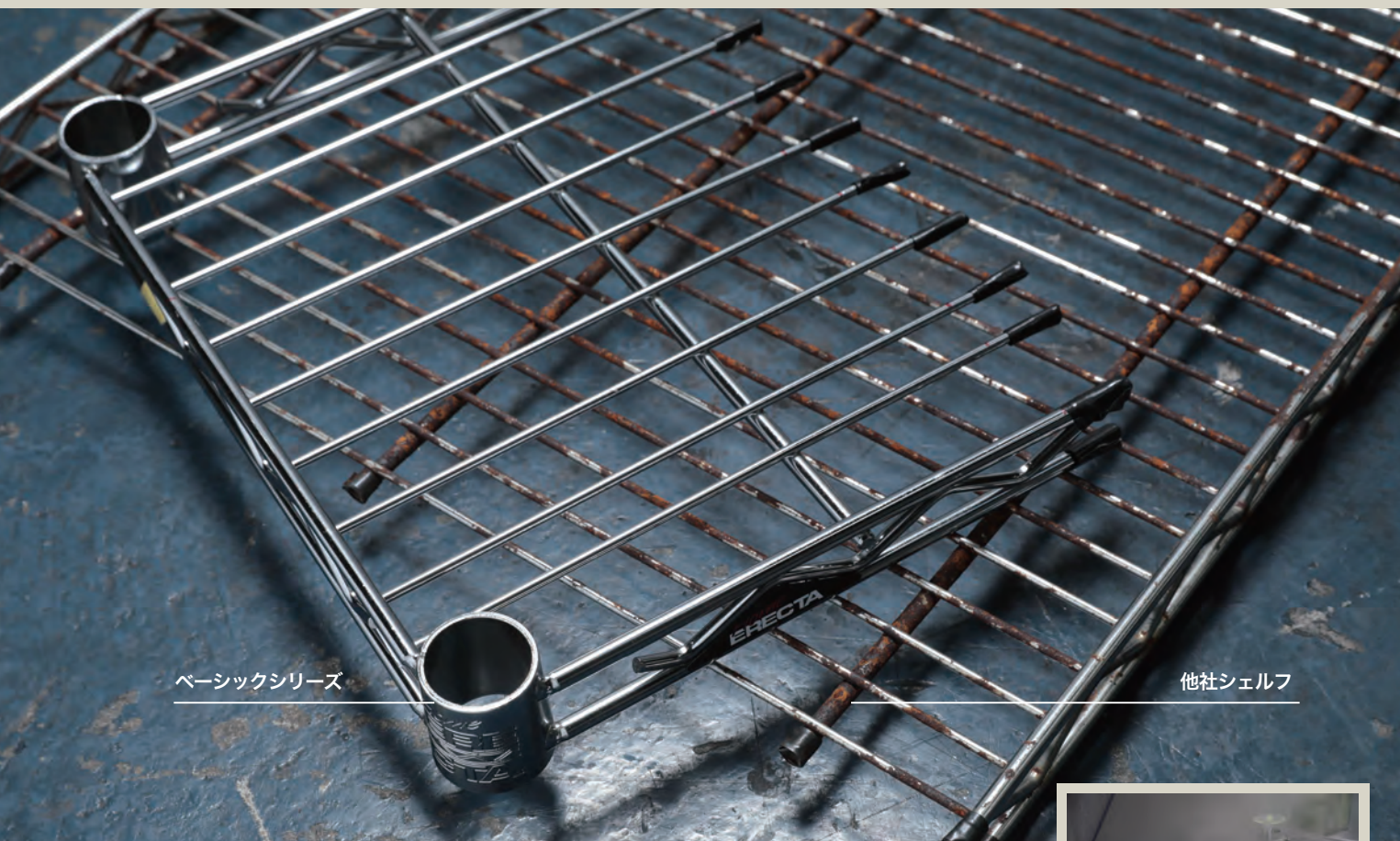
[ 72時間の塩水噴霧試験結果 ]
