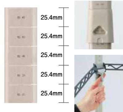
25.4mm間隔で棚の高さを調整することができますので限られたスペースの中で高い収納効率を実現します。ナンバー表示付きポールの採用で、位置決めも容易です。棚板の四隅にあるコーナーレバーを引くだけで、スピーディに棚間隔の調整ができます。耐荷重も棚1段あたり363kgと強靱で堅牢な構造です。
