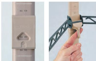
棚間を24.5mmピッチで調整することが可能。棚四隅にあるコーナーレバーを引くだけで、スピーディに棚間隔の調整ができます。耐荷重も棚1段あたり363kgと強靱で堅牢な構造です。
