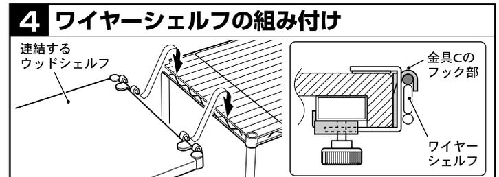
ワイヤーシェルフの下側の線材を、金具Cのフック部に確実にのせて組み付けてください。
