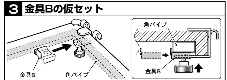
差し込んだ金具A・Cと、ウッドシェルフの裏面にある角パイプとの隙間に金具Bを差し込みます。ローレットねじを時計方向に回し、金具Bの穴にねじ部を差し込んで止まるまで締め込んでください。
