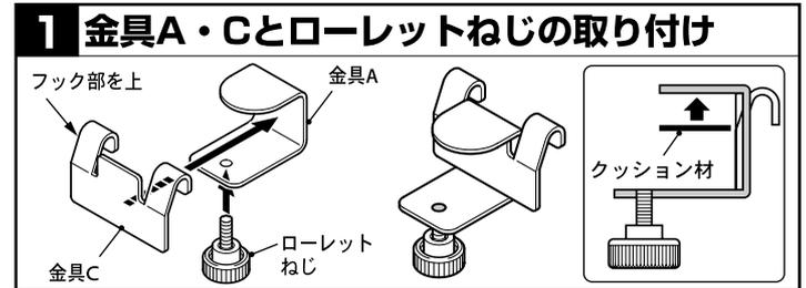
あらかじめ金具Aにローレットねじを取り付けます。(ねじは金具Aから飛び出さないように取り付けてください) さらに、金具Aの裏面にクッション材を貼り付けた後、金具Aに、金具Cのフック部を下側にして密着させます。
