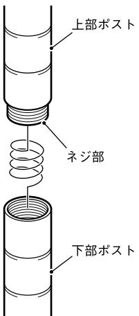
上部ポスト下端のネジ部を、下部ポスト上端の穴にねじ込みます。
