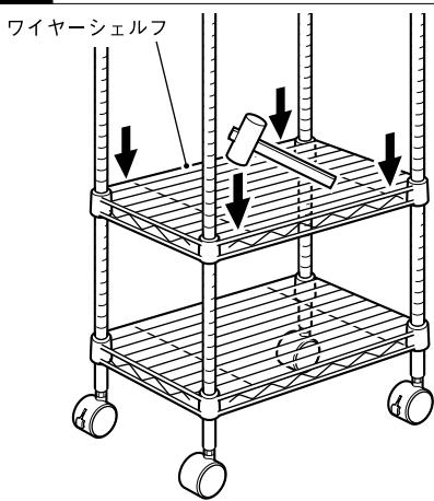
マーカーで印を付けたジョイントポストの溝にスケルトンテープを組み付け、ワイヤーシelfを上から差し込んで固定します。
