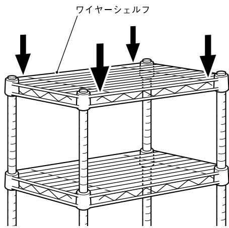
ジョイントポストの最上部の溝にスケルトンテープを組み付け、ワイヤーシelfを載せて固定します。
