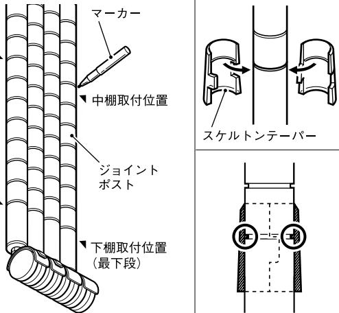
中棚3枚を取り付ける位置を決めて、ジョイントポストの溝にマーカーで印を付けます。
