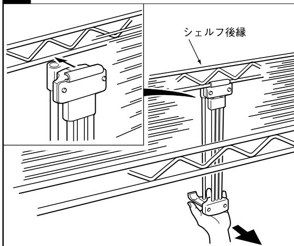
本体を棚に対して垂直の位置にして固定金具をシェルフ後縁に引掛け、固定金具を軸にして少し手前に引いた状態で支えておきます。
