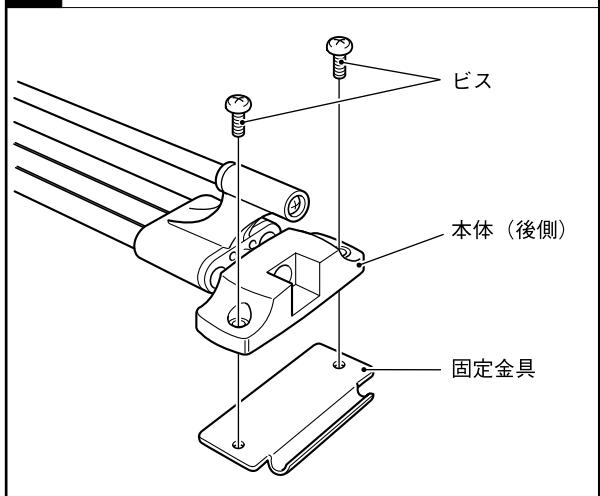
本体の後側に固定金具を、ビス 2 本で取付けます。
