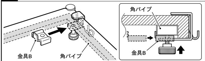
差し込んだ金具A・Cと、ウッドシェルフの裏面にある角パイプとの隙間に金具Bを差し込みます。ローレットねじを時計方向に回し、金具Bの穴にねじ部を差し込んで止まるまで締め込んでください。
