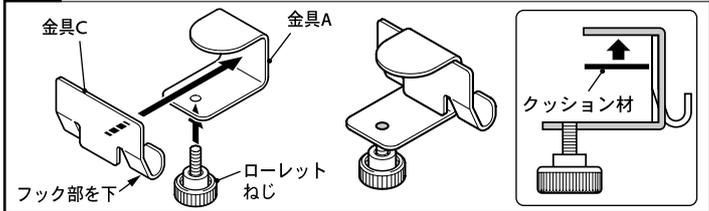
あらかじめ金具Aにローレットねじを取り付けます。(ねじは金具Aから飛び出さないように取り付けてください) さらに、金具Aの裏面にクッション材を貼り付けた後、金具Aに、金具Cのフック部を下側にして密着させます。
