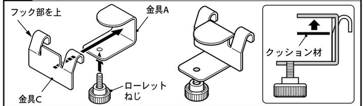
あらかじめ金具Aにローレットねじを取り付けます。(ねじは金具Aから飛び出さないように取り付けてください) さらに、金具Aの裏面にクッション材を貼り付けた後、金具Aに、金具Cのフック部を上側にして密着させます。
