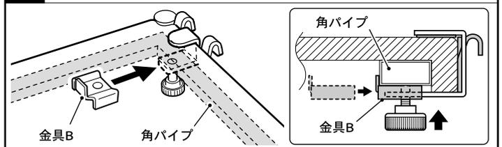
差し込んだ金具A・Cと、ウッドシェルフの裏面にある角パイプとの隙間に金具Bを差し込みます。ローレットねじを時計方向に回し、金具Bの穴にねじ部を差し込んで軽く締め込んでください。
