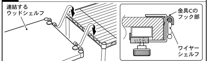
金具Cのフック部を、ワイヤーシェルフの線材の間に引掛けて位置決めします。位置決め後、ローレットねじを止まるまで締め込んでください。
