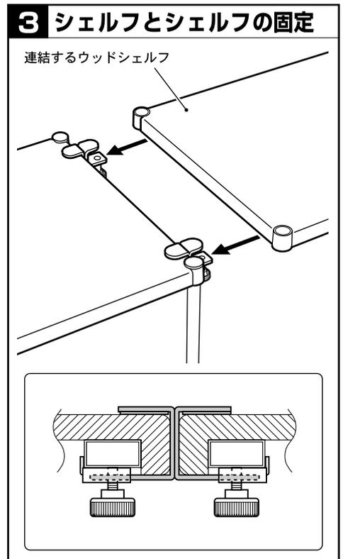
あらかじめ金具Aにローレットねじを取り付けます。(ねじは金具Aから飛び出さないように取り付けてください) さらに、金具Aの裏面にクッション材を貼り付けた後、金具Aをポストの取り付けられているウッドシェルフの縁に差し込みます。
