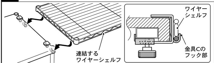
ワイヤーシェルフの下側の線材を、金具Cのフック部に確実にのせて組み付けてください。
