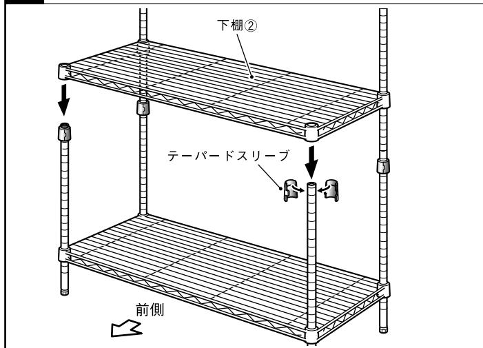
ポストを直立させて棚板の取付位置を決め、**1** のようにテーパードスリーブを組み付けて下棚②を軽く載せます。
