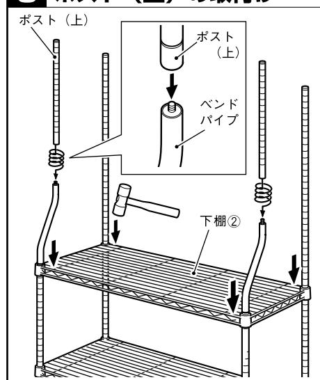
下棚②をプラスチックハンマー等でコーナーリング周辺をたたいて固定した後、ベンドパイプの上端にポスト（上）を止るまでねじ込みます。
