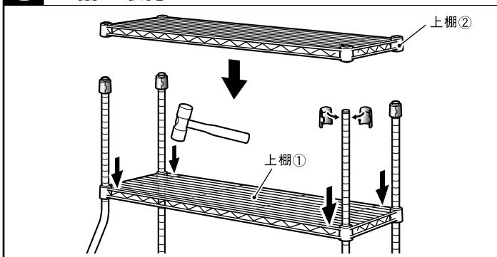
棚板の取り付け位置を決め、**5** の要領で上棚①・②を取り付けます。プラスチックハンマー等でコーナーリング周辺をたたいて固定します。
