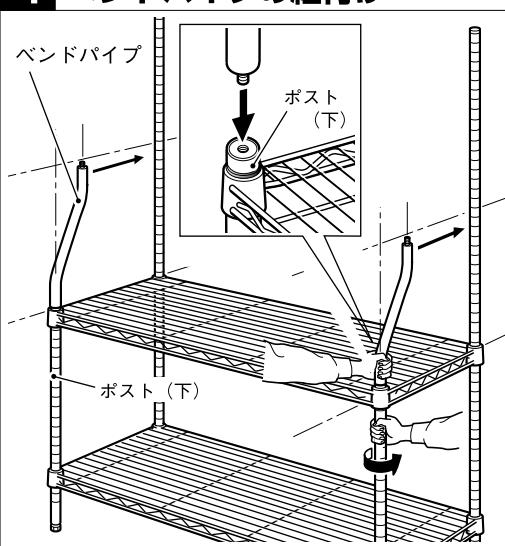
ポスト（下）の頂部にベンドパイプのジョイントボルトを差し込み、ベンドパイプの向きに注意して、支えながらポスト（下）を回して固定してください。
