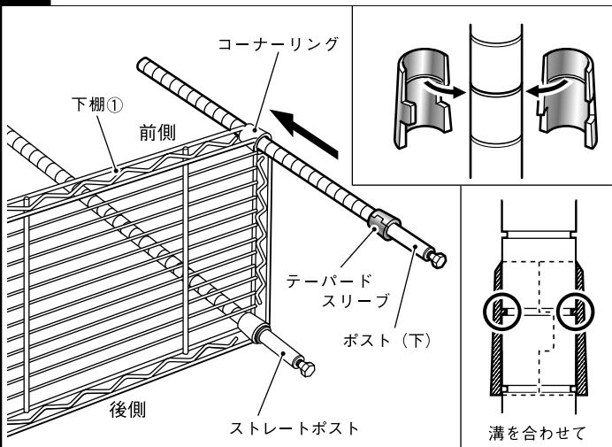
棚板の取付位置を決め、テーパードスリーブを組み付けたポスト（下）、ストレートポストを下棚①のコーナーリングに差し込みます。
