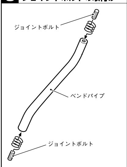
ベンドパイプの両端にジョイントボルトを止まるまでねじ込みます。
