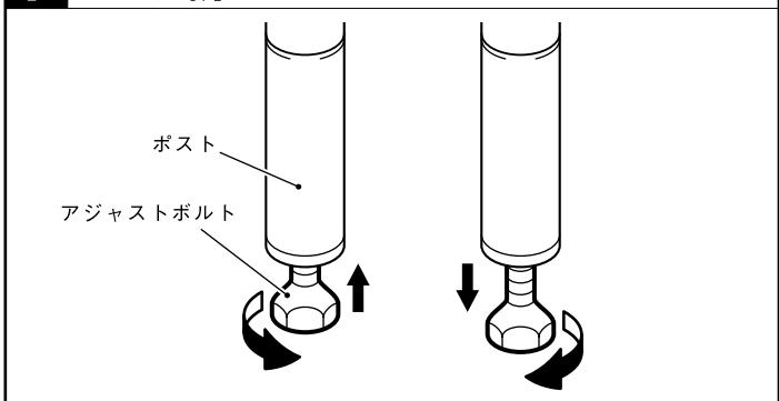
ポスト底部のアジャストボルトで高さを調整し、棚の水平を保つよう調整してください。
