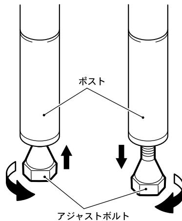
床が水平でないとときは、ポスト下部先端のアジャストボルトを回して、ガタツキがないよう調整してください。
