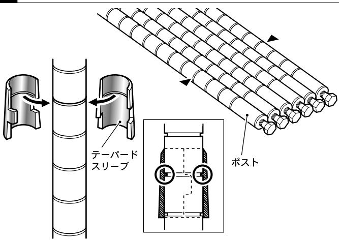
棚板を取り付ける高さにあわせてテーパードスリーブをポスト6本の溝に取り付けます。
