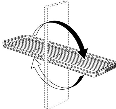
引き出した棚部を長手方向で反転させます。
