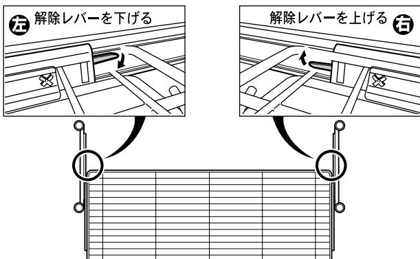
左右レール内側の黒い解除レバーを押します。（解除レバーの操作方向は左右のレールで上下逆になりますのでご注意ください）
