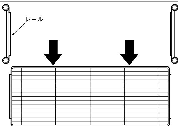
必ず左右均等の力で水平に引き出し、レールから外します。
