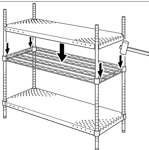
1と同様に、ポストに2段目のテーパードスリーブをセットし、フレームを上から通してテーパードスリーブの位置まで差し込みます。最下段と同様に、フレームをプラスチックハンマー等でたたいて固定してください。カバーをフレームの上に載せます。
