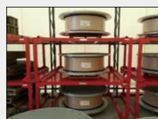
免震ゴム保管
